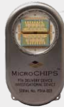
Implant sous-cutané MicroCHIPS : une puce munie de « microréservoirs » de lévonorgestrel et activée par un système sans fil
